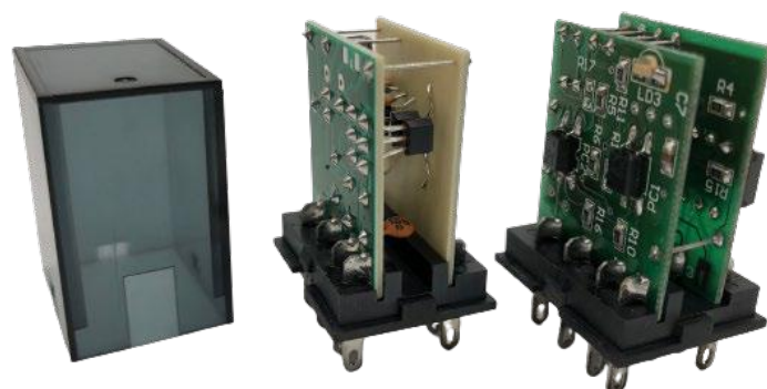
左から(リレーケース、NAND回路搭載、マイコン搭載)
